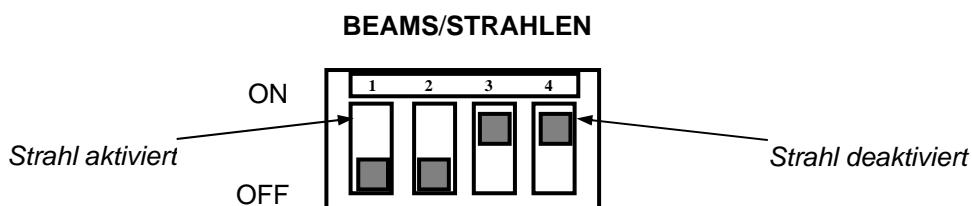
9. Überprüfen Sie die Zentrierung der Strahlen, wobei sicherzustellen ist, dass die entsprechende rote Led sowohl auf dem Master wie auf dem Slave aus ist.
