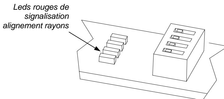
10. Contrôler la facilité d'interruption du rayon en vérifiant, si l'on interrompt le rayon de TX Master vers RX Slave, que la led rouge s'allume aussi bien sur la carte Master que sur la carte Slave, alors que si l'on interrompt le rayon de TX Slave vers RX Master, la led rouge se n'allume que sur la carte Master.
