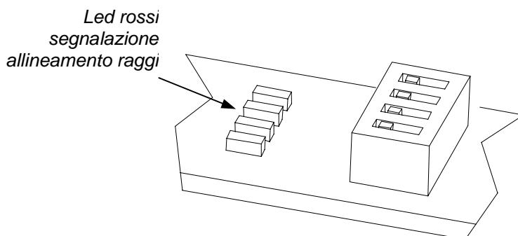
10. Controllare la facilità di interruzione del raggio verificando che interrompendo il raggio da TX Master a RX Slave si accenda il led rosso sia sulla scheda Master che sulla Slave, mentre interrompendo il raggio da TX Slave a RX Master si accenda il led rosso solo sulla scheda Master.
