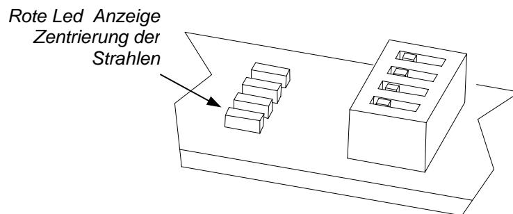
10. Prüfen Sie die Leichtigkeit der Unterbrechung des Strahls, indem Sie sicherstellen, dass bei Unterbrechung des Strahls von TX Master zu RX Slave die rote Led sowohl auf der Master-Karte wie auf der Slave-Karte angeht, während bei Unterbrechung des Strahls von TX Slave zu RX Master nur die rote Led auf der Master-Karte angeht.
